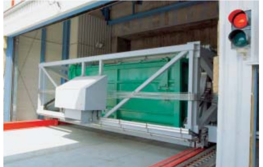
Um jedwede Geruchsbelästigung zu unterbinden, erfolgt die Entladung der Bahncontainer in einer speziellen Luftschleuse.
